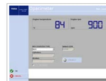
Выбор интерфейса для снятия оборотов двигателя (в данном случае RC3)
